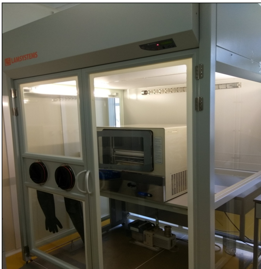
Рис. 1. Размещение аппарата для лиофилизации ПБА I–IV групп в ламинарном укрытии «БМБ-I-«Ламинар-С»
